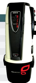
Корпус изготовлен из пластика, полипропилена и ABS-пластика, что делает его устойчивым к атмосферным воздействиям. Уровень защиты IP44 позволяет устанавливать силовой блок в сырой среде, на балконах и в котельных помещениях. Многоразовый картридж из полиэстера с алюминиевыми волокнами класса L очищается при помощи воды.
